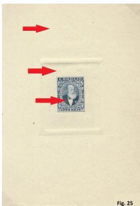
Focou-se o laser do espectrometro em três pontos: no desenho do paletó (por ser o local com maior pigmentação), no quadro dentro do chanfrado e na parte externa do chanfrado (**Figura 25**). Na análise do feixe iônico, havia picos de íons de cálcio (metal alcalino terroso) e ferro (metal de transição),
