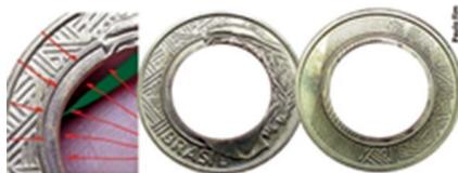
Neste tipo de erro, o anel de uma moeda bimetálica não recebe o núcleo na câmara de cunhagem. O metal do anel se expande para dentro, ocupando parte do espaço que seria do núcleo, em cerca de 1 a 2 mm, em razão da pressão empregada. Moedas adulteradas, nas quais se remove o núcleo, não possuem esse espaço interno reduzido, sendo detectadas visualmente com facilidade.
