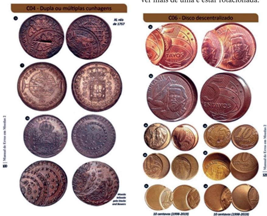
Deve-se observar que este erro não é causado no momento da fabricação do cunho, mas no processo de cunhagem, com detalhes da duplicação do mesmo ponto do cunho inverso. Ele
